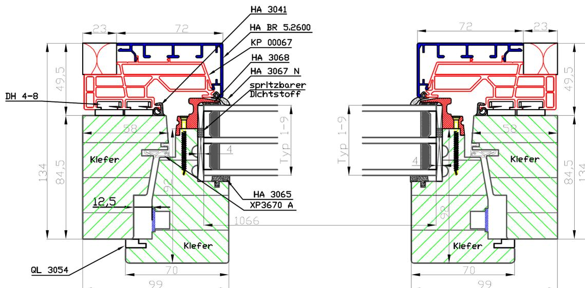
**Bild 4** Horizontalschnitt, geprüft wurde mit 8 VSG/18/4/18/6 Verglasung (Typ 4)
