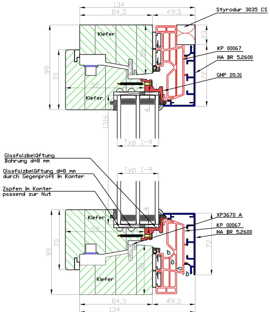
**Bild 3** Vertikalschnitt, geprüft wurde mit 8 VSG/18/4/18/6 Verglasung (Typ 4)
